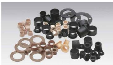
Kunststoff-Gleitlager entstehen im Spritzgussverfahren, sind durch den Zusatz von Schmierstoffen wartungsfrei und daher ideal für den Einsatz in der Medizintechnik, der Nahrungsmittel-, pharmazeutischen und chemischen Industrie geeignet.
