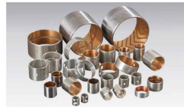
Bimetall-Gleitlager widerstehen schweren Lasten und Stössen. Auf ein Trägerblech wird dazu eine metallische Gleitschicht gesintert. Je nach Anwendung stehen unterschiedliche Bronzelegierungen zur Verfügung. Diese Lager sind nicht wartungsfrei und benötigen eine gute Schmierung.
