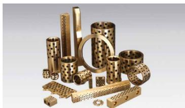
Gleitlager und Gleitelemente aus Kupferlegierungen sind geeignet für hohe Belastungen bei niedrigen Gleitgeschwindigkeiten. In die Gleitflächen werden in regelmässigen Abständen Festschmierstoff-Depots eingelassen.
