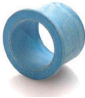
Die Composite Gleitlager werden aus Verbundwerkstoffen maschinell gefertigt, die aus fein gewebten Kunststoffgeweben bestehen, welche mit speziellen duroplastischen Polyesterharzen imprägniert sind. Zur Verbesserung der mechanischen Eigenschaften, insbesondere des Reibungskoeffizienten, wird das Harz mit verschiedenen Aditiven versehen.
