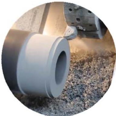
Verbundwerkstoffe können bei Bedarf mit externer Schmierung verwendet werden. Wir sind in der Lage, kundenspezifische Lager und Verschleisspolster mit Schmiernuten für Wasser, Fett oder Öl herzustellen. Sollten Sie sich für eine externe Schmierung entscheiden, empfehlen wir die Verwendung von Wasser oder synthetischem Öl/Fett.
