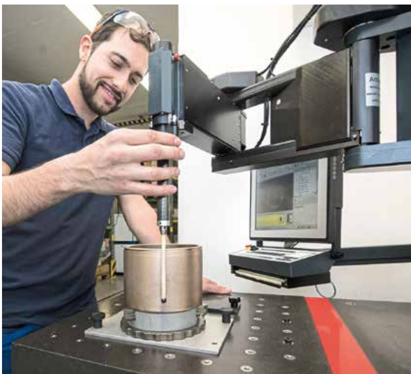
Die Endabnahme und Kontrolle ist entscheidend, damit das Gleitlager seine Funktion sicher erfüllt.
